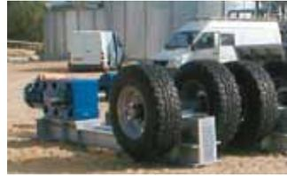
Châssis de fixation permettant un entraînement direct, réducteur avec trains de pneus ; solution sans poulies / courroies.
