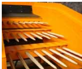
Barreaux de scalpage forgés Pour le prériblage des produits colmatants
