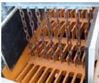
Bas de trémie statique Avec rideau de chaînes ou rideau de plaques
