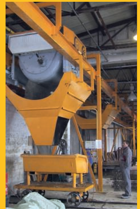
Der SKAKO CONFLEX Betonkübelwagen erreicht die Entleerstation.
