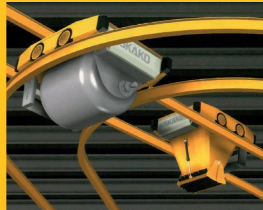
En virage, CONFLEX utilise le plus court rayon de courbure possible.
