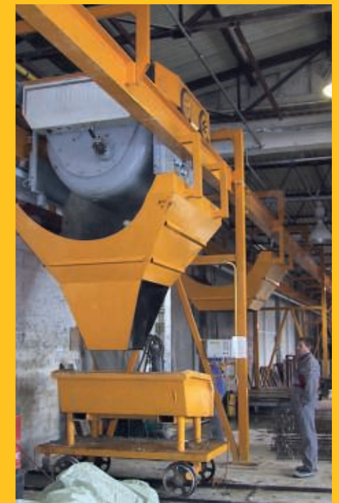
Une benne SKAKO CONFLEX arrive à une station de coulage.
