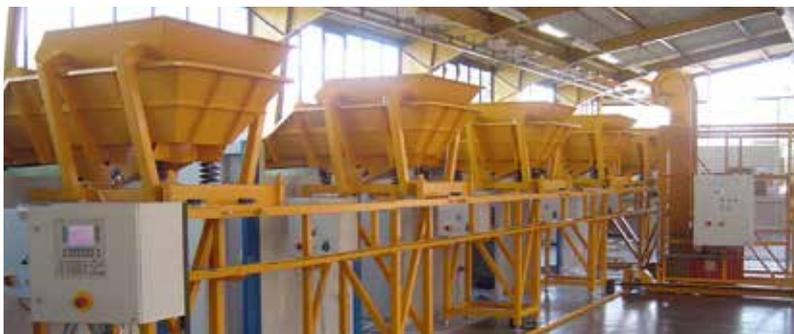
Nos appareils sont livrables mobiles sur rails, permettant une distribution économique des produits, par exemple pour plusieurs trémies d'alimentation en ligne.
