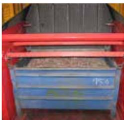
La barre de verrouillage se règle manuellement en fonction des différentes hauteurs de conteneurs.
