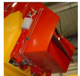
Le basculement pas à pas permet un remplissage partiel de la trémie d'alimentation par exemple, ce qui permet aussi d'éviter agglomération de certains produits difficiles à manutentionner.
