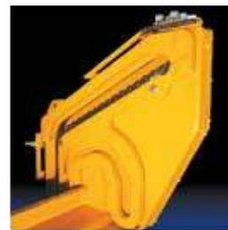
Un guidage «anti-bourrage» pour les roues du monte-charge, conçu pour un service intensif, est inclus en version standard.
