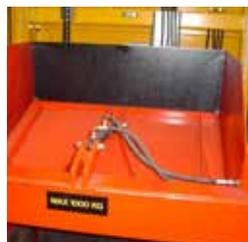
Le couvercle pneumatique/hydraulique assure un transfert en douceur des produits du conteneur vers la machine suivante, par exemple une trémie d'alimentation.
