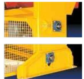
Accès direct au réglage de tension de la chaîne. Combiné au repositionnement facile de la roue de la chaîne, le dispositif de réglage de la chaîne indique avec précision le moment du prochain remplacement de la chaîne.
