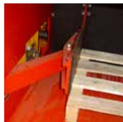
Un dispositif de fixation pneumatique/hydraulique (selon la taille de l'élévateur basculeur) facilite le blocage des conteneurs de tailles variables.
