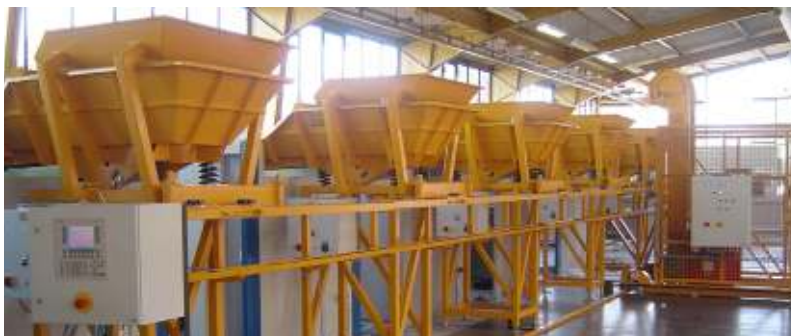
Der auf Bodenschienen fahrbare Kipplift ermöglicht eine wirtschaftliche Beschickung von z.B. mehreren in Reihe stehenden Vorratsbunkern mit nur einem Kipplift.
