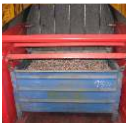
Manuell verstellbarer Sicherungsbügel in der Lastaufnahme für das Sichern von unterschiedlichen Behälterhöhen.
