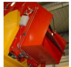
Getaktetes Auskippen ermöglicht das Entleeren des Behälters in mehreren Etappen und optimiert das Entzerren von sehr stark verhakenden und schwer dosierbaren Produkten.
