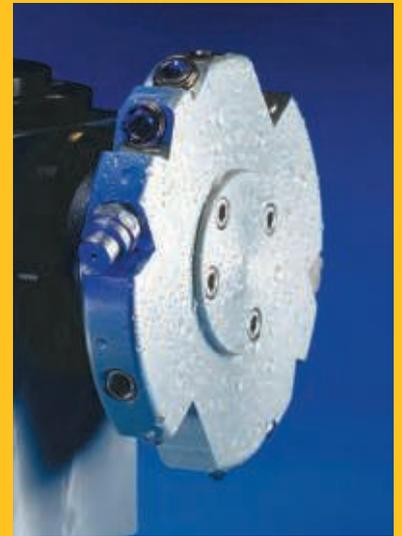
Le dispositif de nettoyage haute pression est doté d'une tête rotative. Cette tête envoie un jet d'eau sous haute pression à l'intérieur du malaxeur de manière à déloger toutes les salissures. Lors du nettoyage les pales raclent les parois internes éliminant les restes de béton. A l'immobilisation, il suffit de vider et le nettoyage est alors terminé.
