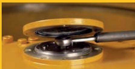
Les outils de malaxage peuvent être facilement réglés dans la position optimale lors de la maintenance.
