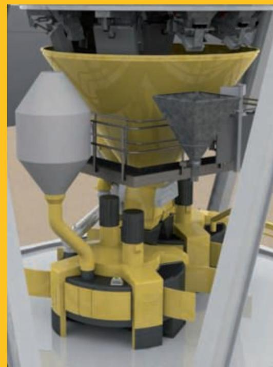
La plateforme de grandes dimensions facilite le nettoyage et permet l'installation de malaxeurs contre-courant ou de malaxeurs à double arbres horizontaux.
