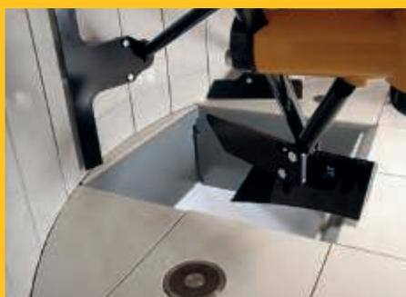
Vidange accélérée de près de 23 % grâce à la grande trappe à commande hydraulique. L'ouverture étant à basculement vers le bas, une plateforme de dimensions réduites suffit.
