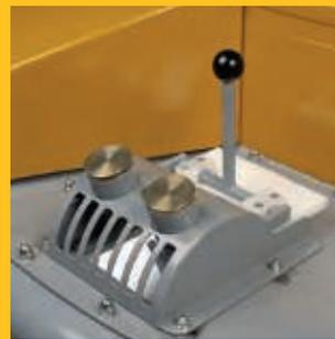
Accès aisé à la trappe d'inspection à des fins de contrôle visuel du malaxage.
