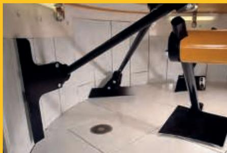
La conception unique des pales sur deux niveaux assure un malaxage plus intense. Les boulons sont du type à tête noyée de manière à éviter la pollution des nouvelles gâchées par du béton provenant des précédentes.
