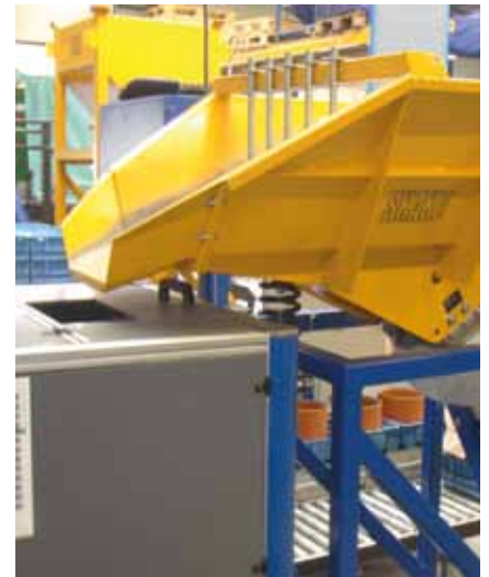
Vorratsbunker vor Sortierautomat
