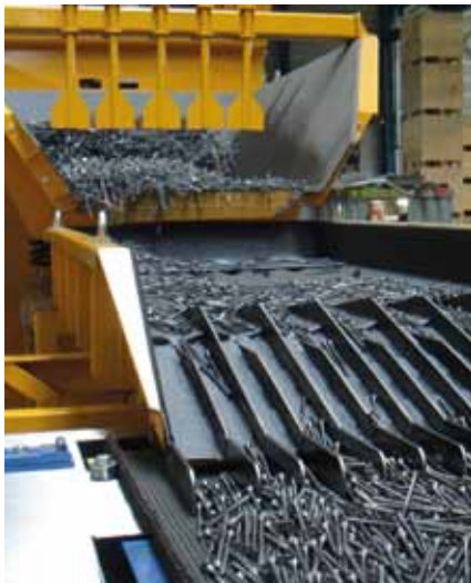
Vorratsbunker (bis 2.0t) für Ofenbeschickung
