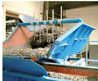
L'utilisation d'une trémie de stockage, combinée à un couloir de transport, permet un dosage automatique précis des matériaux les plus enchevêtrés.
