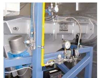
Des couloirs vibrants avec motovibrateurs, entièrement construits en aciers réfractaires permettent le chargement des fours à sole interne.
