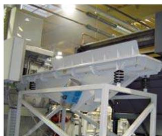
Des couloirs vibrants avec moteurs à balourds permettent le transfert en continu des produits entre les équipements.
