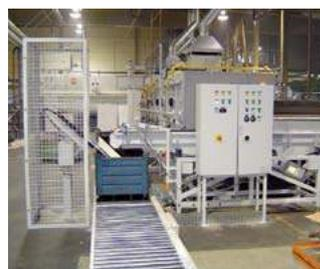
Des systèmes en sortie de ligne permettent un reconditionnement contrôlé, avec ou sans pesage, des produits traités dans les conteneurs.
