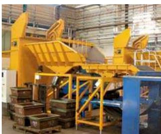
Une installation de chargement complète intègre un élévateur-retourneur, une trémie vibrante avec son système de pesage et un couloir vibrant de distribution.
