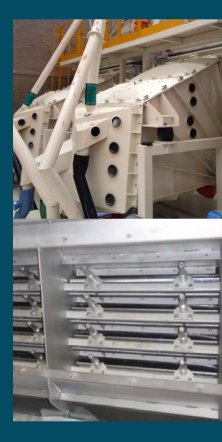
La sustitución de las mallas, gracias al óptimo diseño de estas cribas, se realiza rápida y cómodamente por la parte trasera de las mismas, a una altura de operación ideal.
